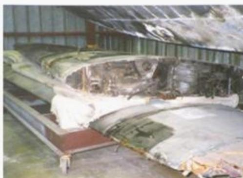
② 保管棟の主翼、木製翼端部、親子式フラップ、桁構造に注意
