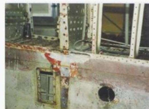
⑧表皮が剥がされた主翼、腐食の目立つ主桁部とガソリントankに注意
