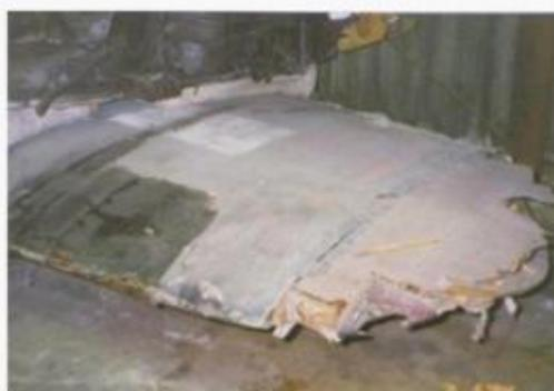
③ 保管棟の主翼、木製翼端部、親子式フラップ、桁構造に注意
