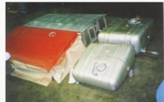
⑨ガソリントankは主翼に4個、セミインテグラルtankと独立tank各2個
