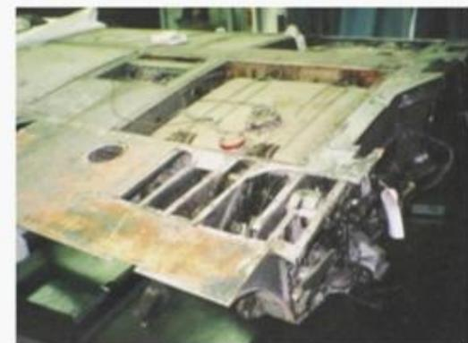
⑦表皮が剥がされた主翼、腐食の目立つ主桁部とガソリントankに注意
